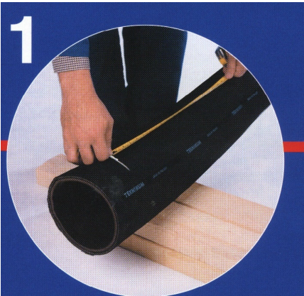
Schlauch ablängen, Schnittstelle markieren
