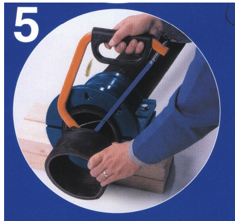
Stahlspirale mit Eisensäge durchtrennen
