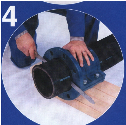
Schlauchende passgenau entlang der GRANIT SELECT-/TITAN SELECT- Kupplung mit Schlauchmesser ablängen
